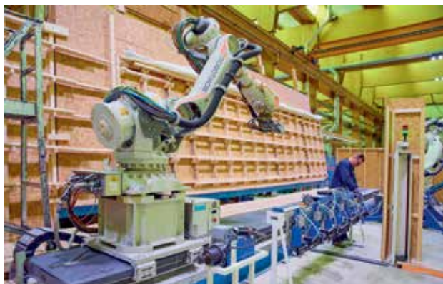
Assemblage des murs (1/2).
